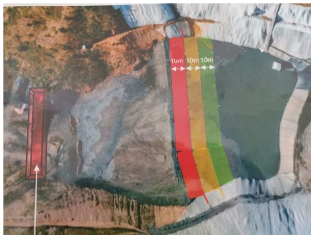
Слика 3 Тригер нивоа за хоризонтално растојание на водата во таложното езеро од круната на браната
