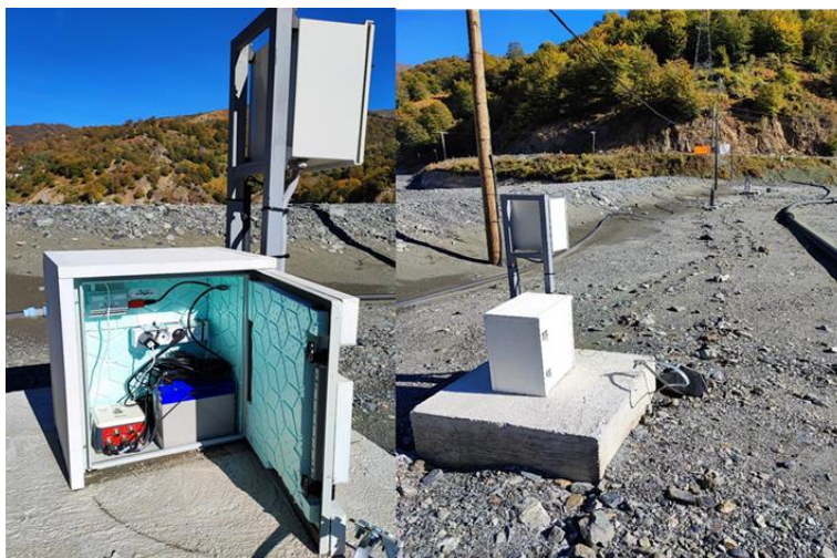
Слика 8 Мерни инструменти за сеизмички мерења
